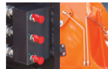
Порты централизованной системы смазки
