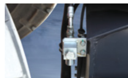
Дистанционная система слива моторного масла и охлаждающей жидкости
