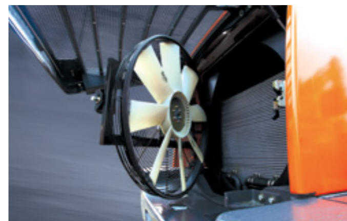
Поворотно-откидной вентилятор охлаждения
